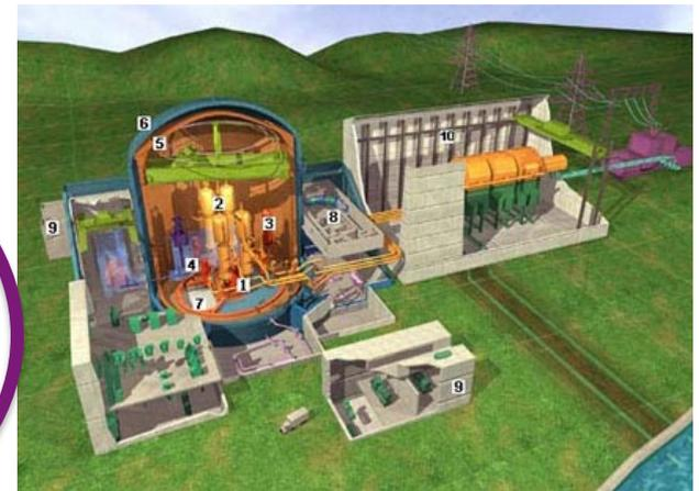
Réacteur à ébullition (ou: à eau bouillante)
